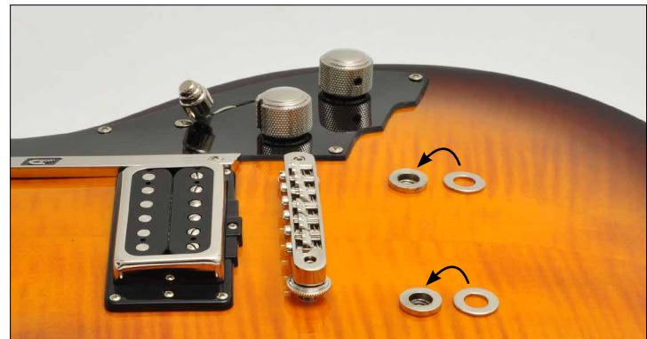
Jetzt das Tremolo einmal vorsichtig auf die Gewindehülsen setzen. Es darf nicht auf der Decke aufliegen. Falls es das doch tut, einfach vor der Montage jeweils eine oder zwei der beiliegenden Scheiben unterlegen.
